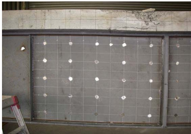
図 4.51 コンクリートの圧壊(ケース(1))
