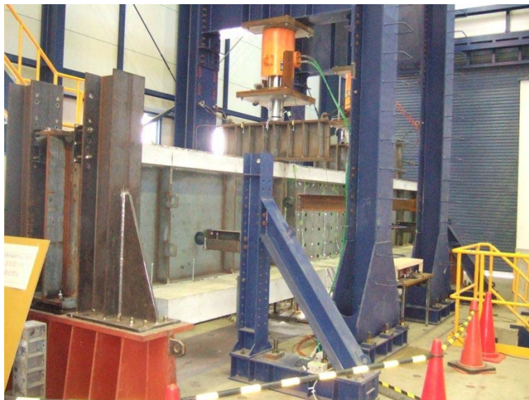
図 3.3 供試体設置状況（供試体 A）
