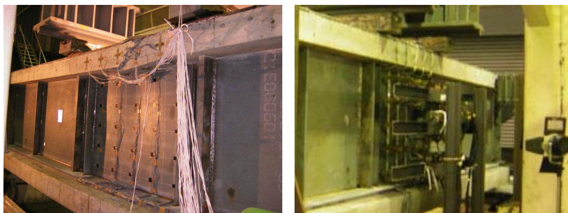
図 3.7 供試体 B のゲージおよび変位計設置状況
