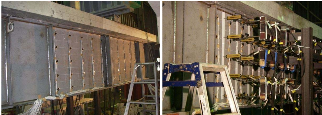
図 4.24 腹板へのゲージおよび変位計設置状況
