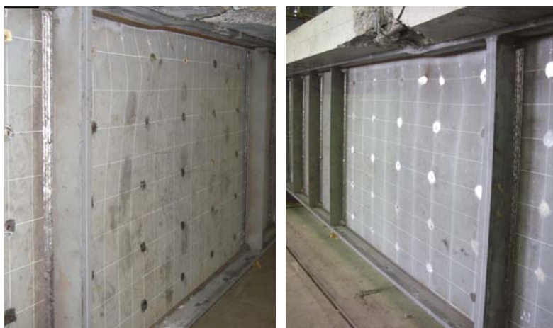
図 4.55 ウェブの変形(ケース(2))
