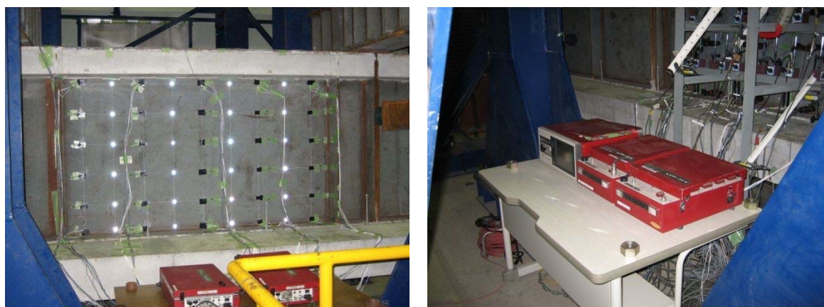
図 3.6 供試体 A のゲージおよび変位計設置状況
