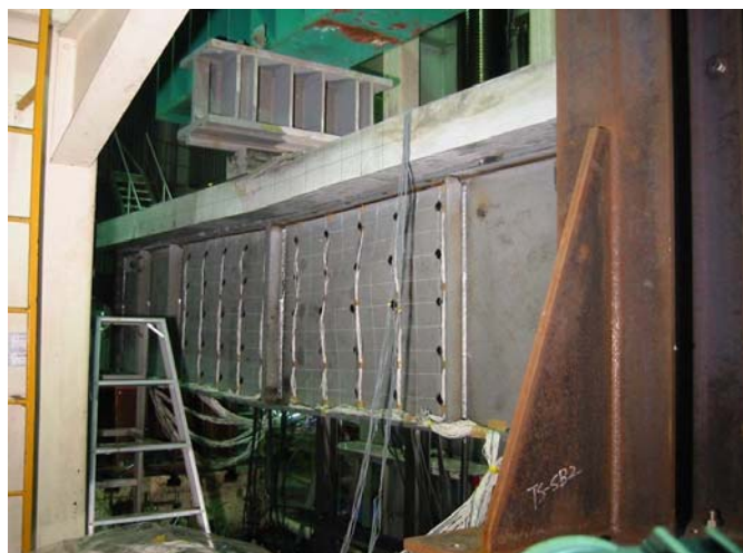
図 4.14 曲げせん断実験（ケース1）供試体設置状況
