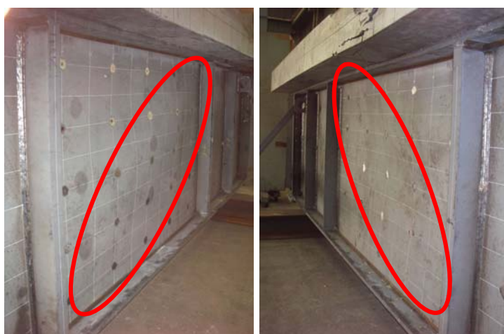
図 4.52 ウェブの変形(ケース(1))
