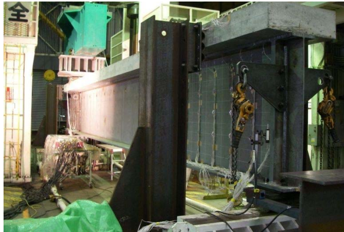
図 4.12 せん断実験供試体設置状況
