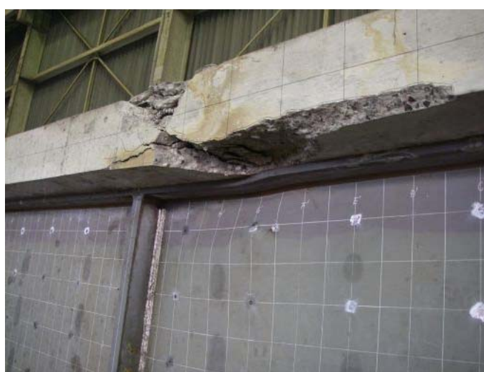
図 4.54 コンクリートの圧壊と鋼桁の変形(ケース(2))
