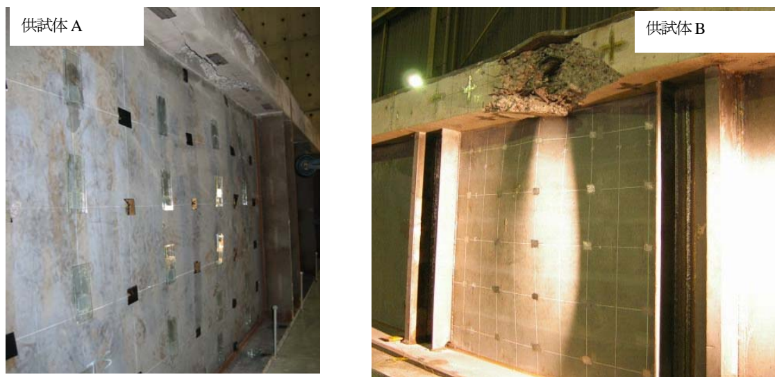
図 3.14 コンクリートブロック破壊状況
