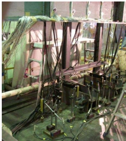
図 4.25 鉛直変位計設置状況
