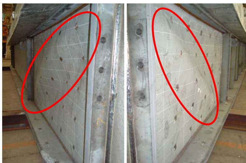
図 4.39 終局時ウェブパネルの斜め張力場( \alpha=2.0 )
