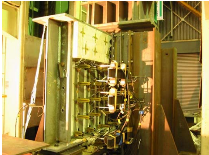
図 4.13 2重合成せん断実験供試体設置状況
