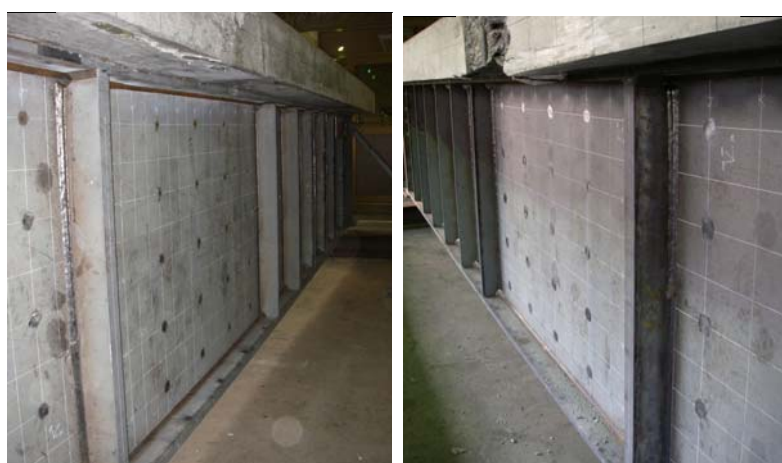
図 4.57 ウェブの変形(ケース(3))
