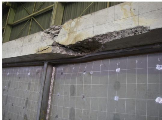
図-11 コンクリートの圧壊と鋼桁の変形(ケース(2))
