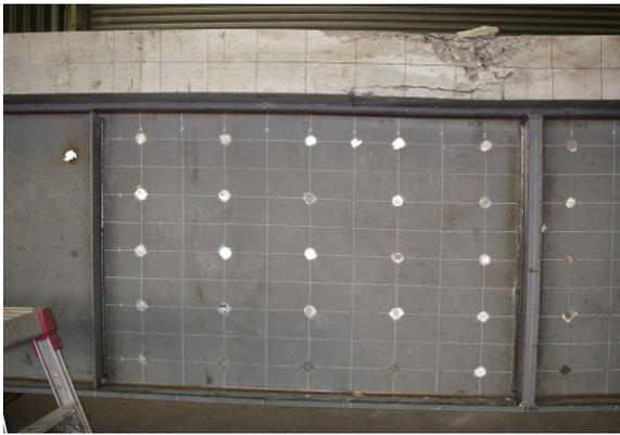
図-8 コンクリートの圧壊(ケース(1))
