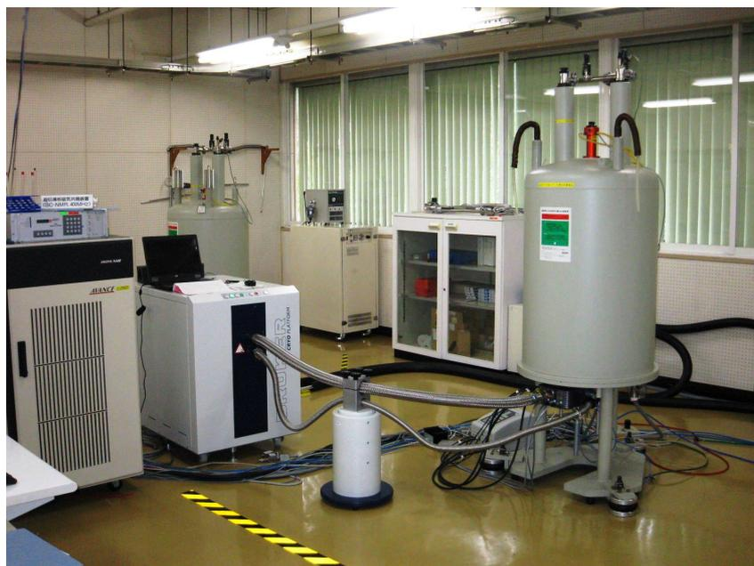
図1. システム全景(高感度化核磁気共鳴分子構造解析システム)
