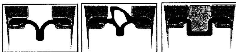
(a) 普通止水ゴム断面 (b) 新型止水ゴム断面 (c) 止水ゴム空間閉塞
