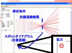
光線追跡シミュレーション(V-Opt)解析事例
