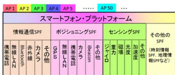
図12 センシングSPFが特徴的なスマートフォン・プラットフォーム。
