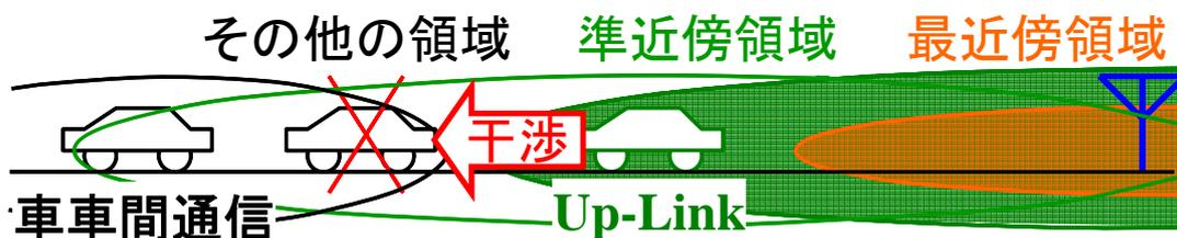
図 5.2 車車間通信が路車間通信から干渉を受ける状況
