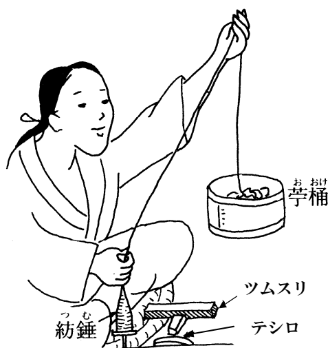
第2図 紡錘車の使用方法[竹内1989]を一部修正
