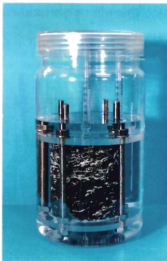
図-48 透水試験装置(Type3)
