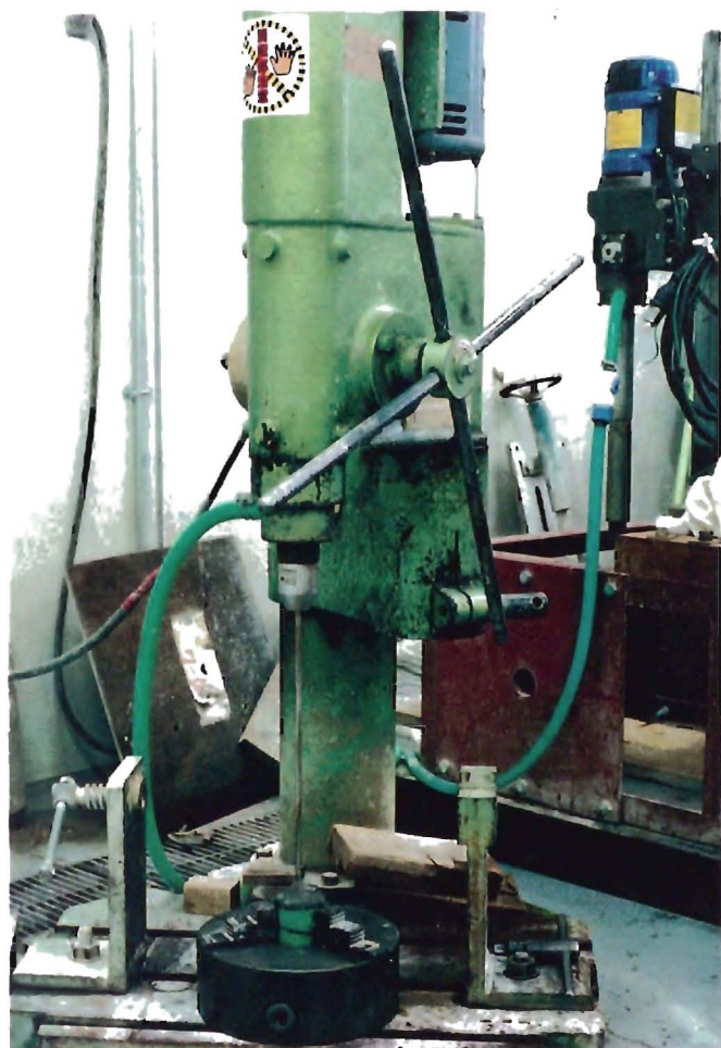
図-49 中空円筒供試体作成状況
