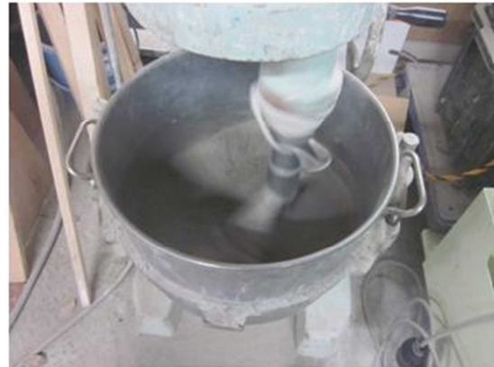
写真－2 モルタルの練り混ぜ
