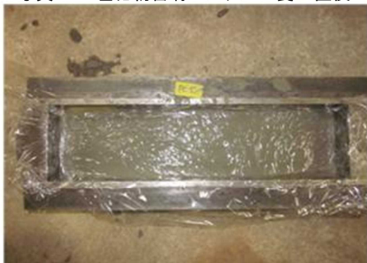
写真－5 塩化物含有モルタルの水分蒸発防止
