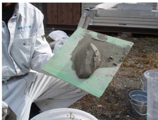
写真-2 補修用モルタルのフレッシュ性状
