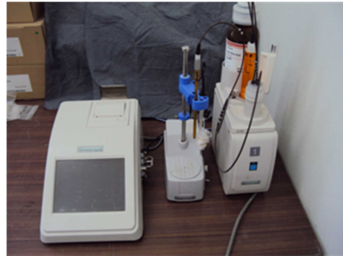
写真-3.3 塩化物イオン選択性電極を用いた電位差滴定法装置
