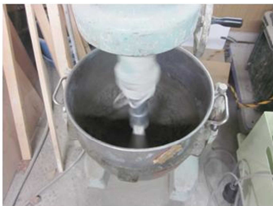
写真-1 モルタルの練り混ぜ
