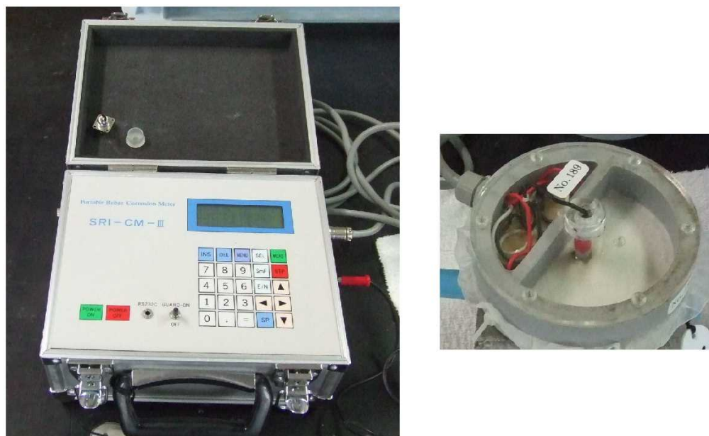
写真－6.1 携帯型鉄筋腐食診断器
