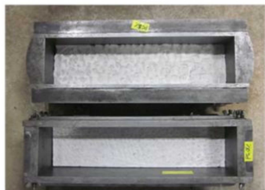
写真－4 塩化物含有側と補修用側との界面
