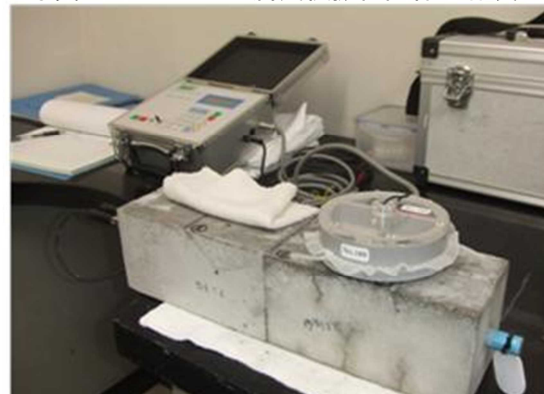
写真-4 マクロセル腐食模擬供試体の鋼材診断
