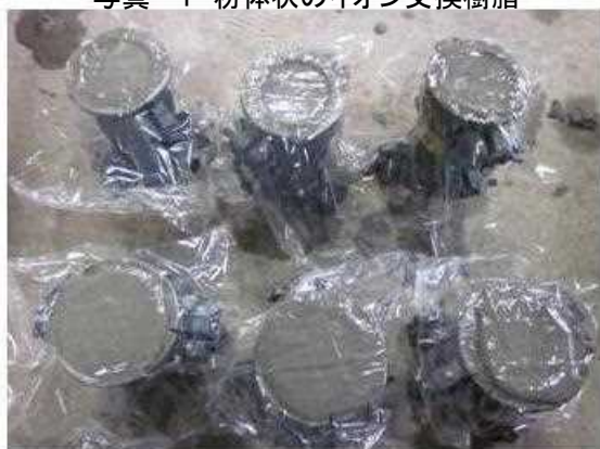
写真-3 圧縮強度試験用の供試体の養生
