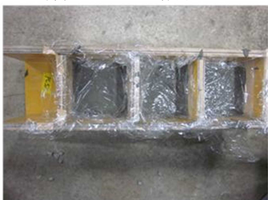
写真-3 塩分含有モルタルの養生
