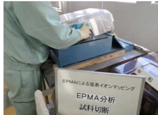
写真－6 EPMA 用供試体の切断
