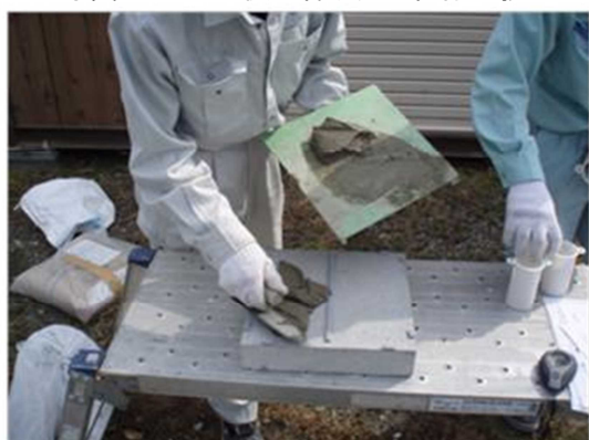
写真-3 定期的な品質管理試験用供試体作製
