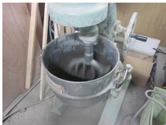
写真-2 モルタルの練り混ぜ
