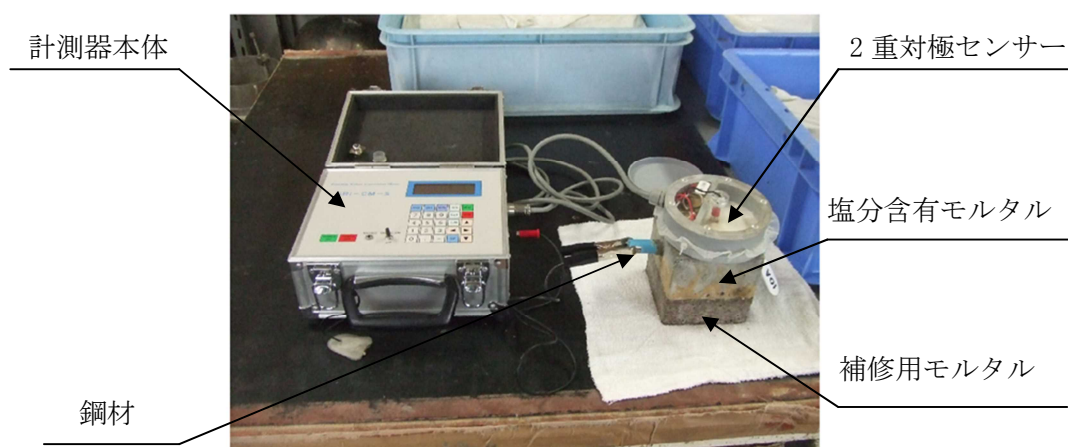
写真-6.2 腐食度の測定・診断状況（ミクロセル腐食）
