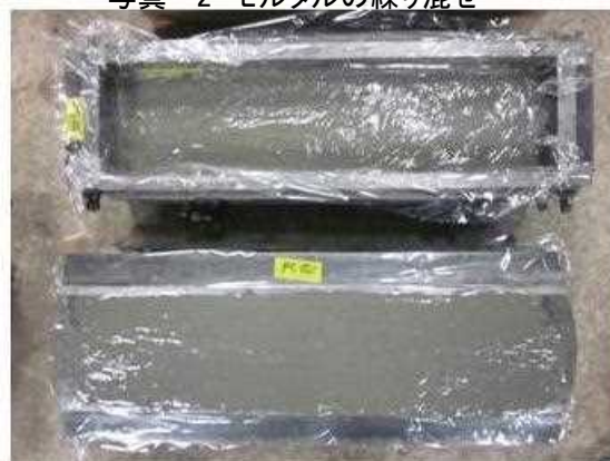
写真-4 塩分浸漬試験用の供試体の養生
