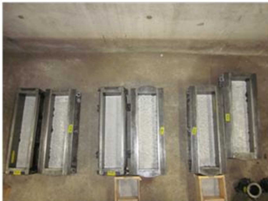
写真－3 塩化物含有モルタルの養生直後
