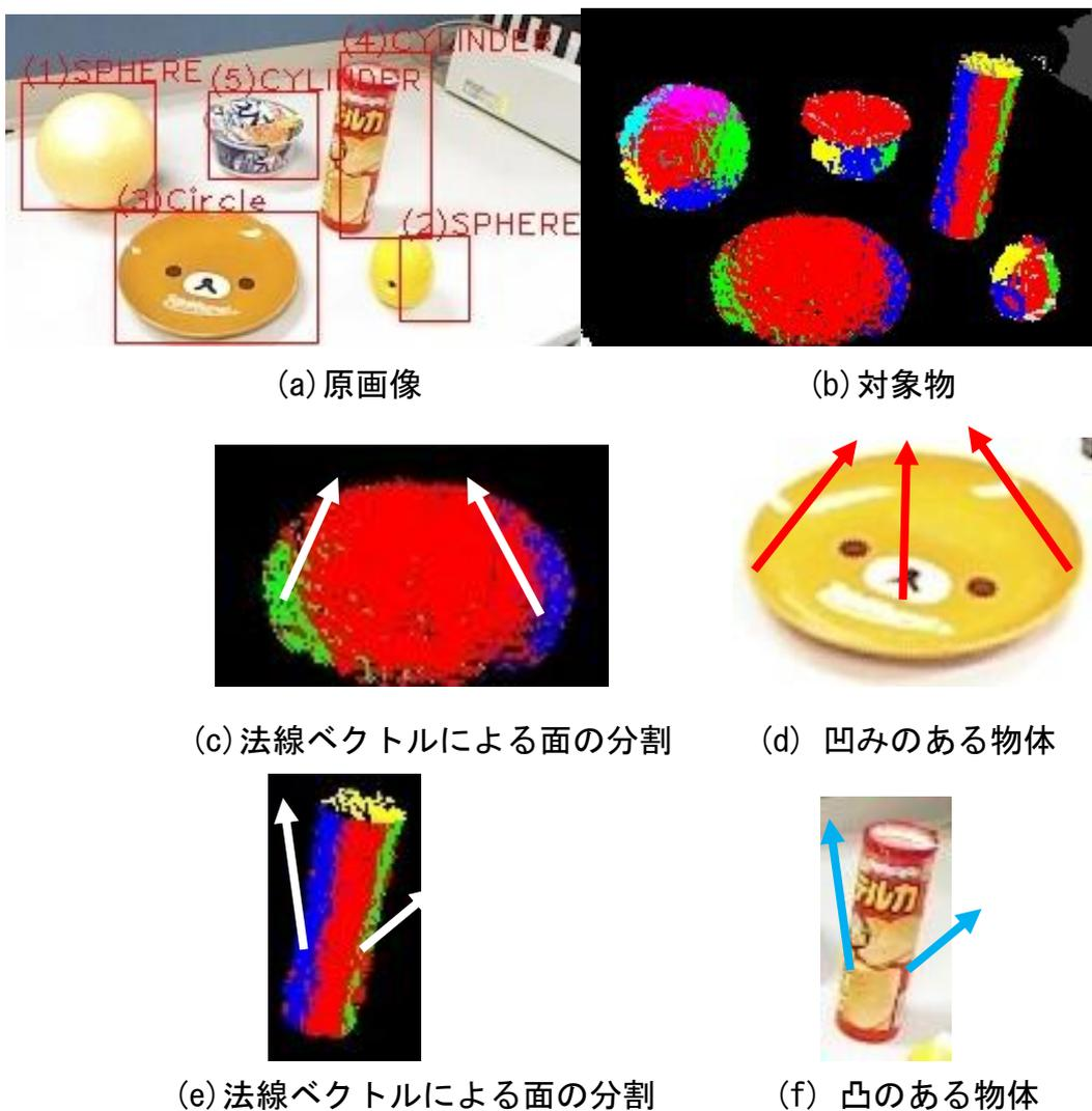
図 3.13 : 法線ベクトル方向による凹凸の認識
