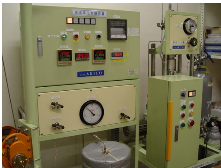
図 2.7 高温高圧装置の写真。370 °C，60～90 MP の高温高圧環境を作る事ができる。
