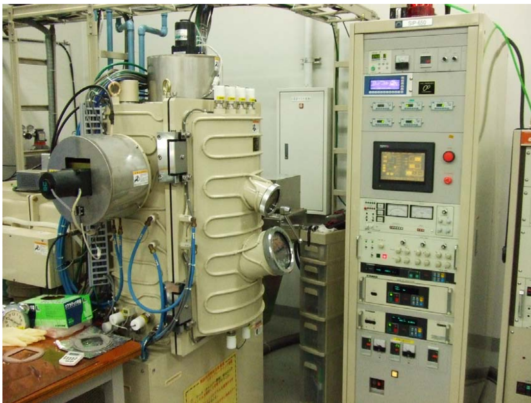
図 2.16 利用したイオンプレーティング装置。埼玉県産業技術総合センター所有の装置である。
