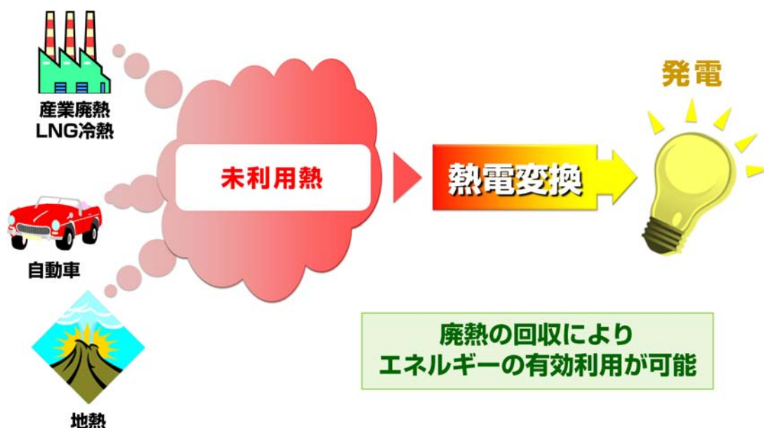
図 1.7 熱電変換素子を利用したエネルギーの有効利用の概念図．熱電変換素子を利用して未利用熱から電気エネルギーへ変換する事で，エネルギーの有効利用が可能になる．
