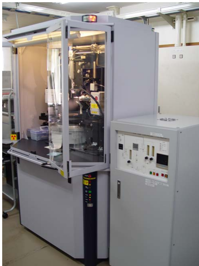
図 2.9 利用した Bruker 社製単結晶 X 線構造解析装置。埼玉大学科学分析支援センター所有。
