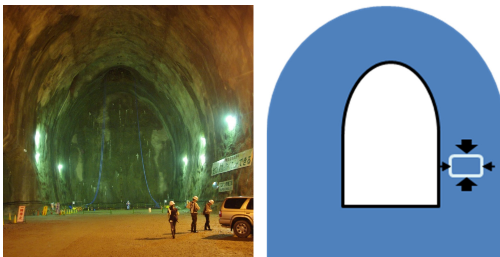
図 1-4 地下構造物の空洞周辺の応力状態
