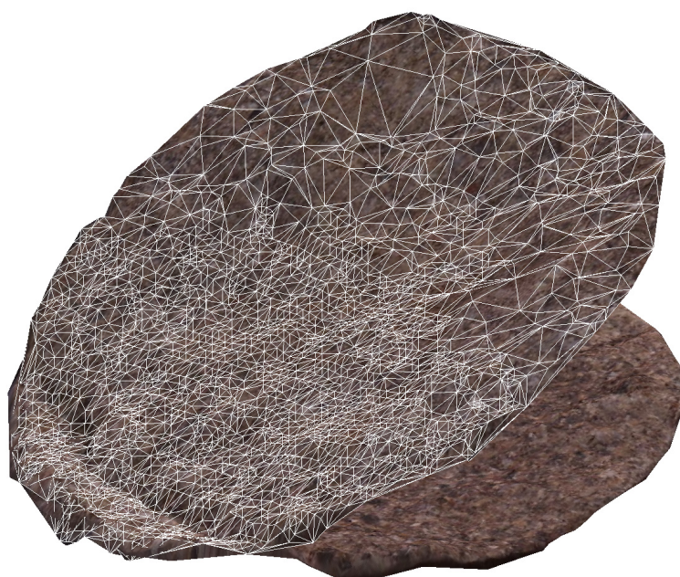
図 4-9 K-18-1 試料から写真測量で作成した破断面形状モデル
