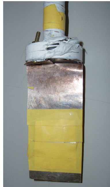
図 4.14: 銀ホイルの上からさらにカプトンで包んだ試料
