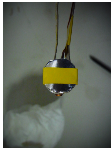
図 4.12: ミニクライオスタットにセットした試料
