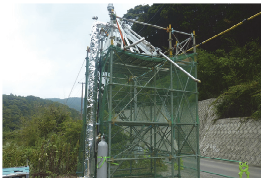
写真 6.4.4 液体窒素噴射装置
