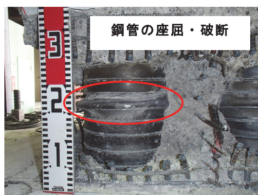
写真 5.2.2 鋼管の破断状況 (実験終了後)
