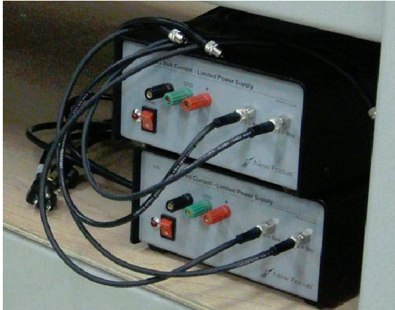
図 A.11: 電気信号増幅器用の15V電源
