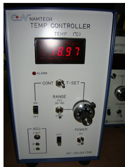
図 A.4: 温度コントローラ
