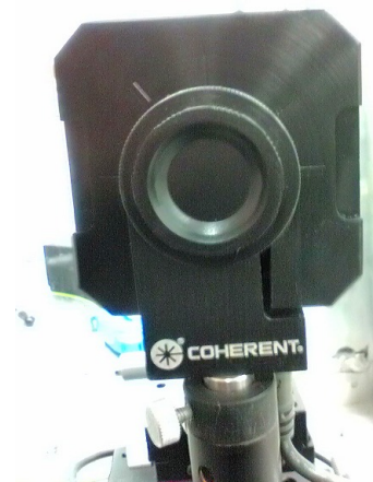
図 A.31: レーザビームプロファイラ
