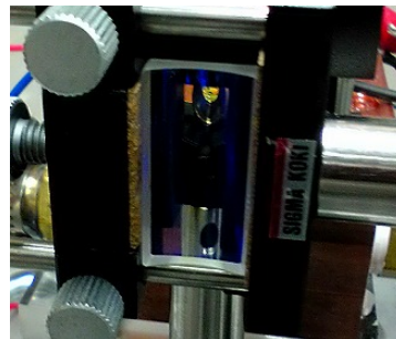
図 A.18: レーザコリメート用レンズ (a) f = 2.97 非球面レンズ, (b) f = 100 円筒面凸レンズ,(c) f = -25 円筒面凹レンズ
