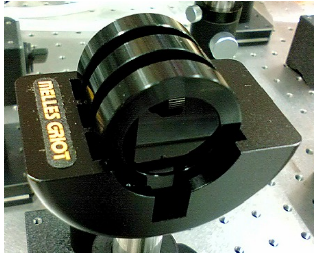
図 A.25: (a)OD4.0 吸収型 NDF,(b) 枠付き吸収型 NDF (OD0.6×2,OD1.3×1)
