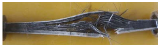
HFRP flange 90°C
