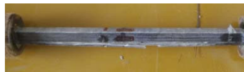
HFRP flange 50°C
