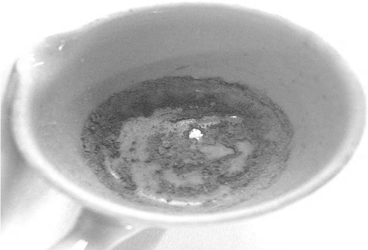
図6 鉄粉を希塩酸に溶かして加熱し，ギリギリまで加熱して水分をほぼ完全に
