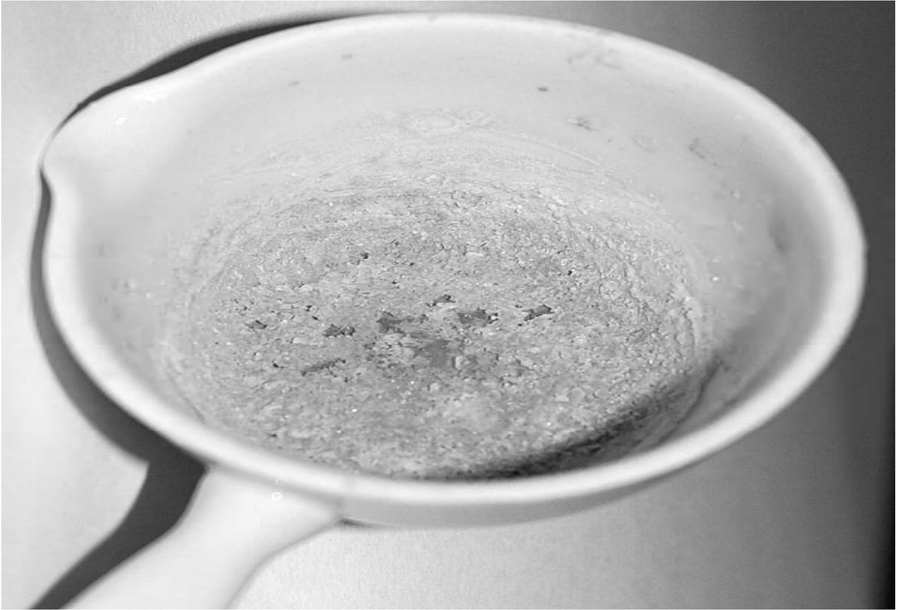
図3 スチールウールを希塩酸に溶かして加熱し、ギリギリまで加熱して水分をほぼ完全に除去した試料
