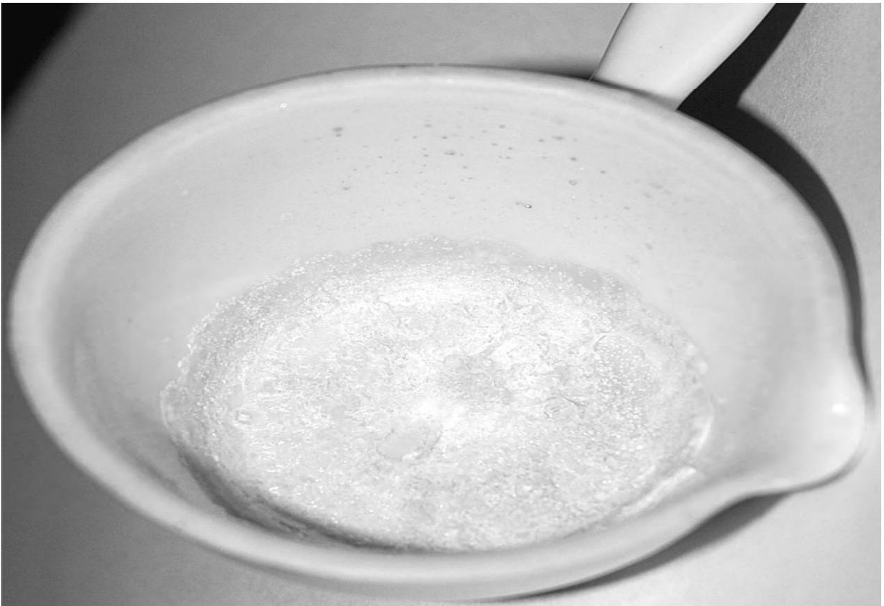
図2 スチールウールを希塩酸に溶かして加熱し、早め加熱を止めて水分を少し残した試料
