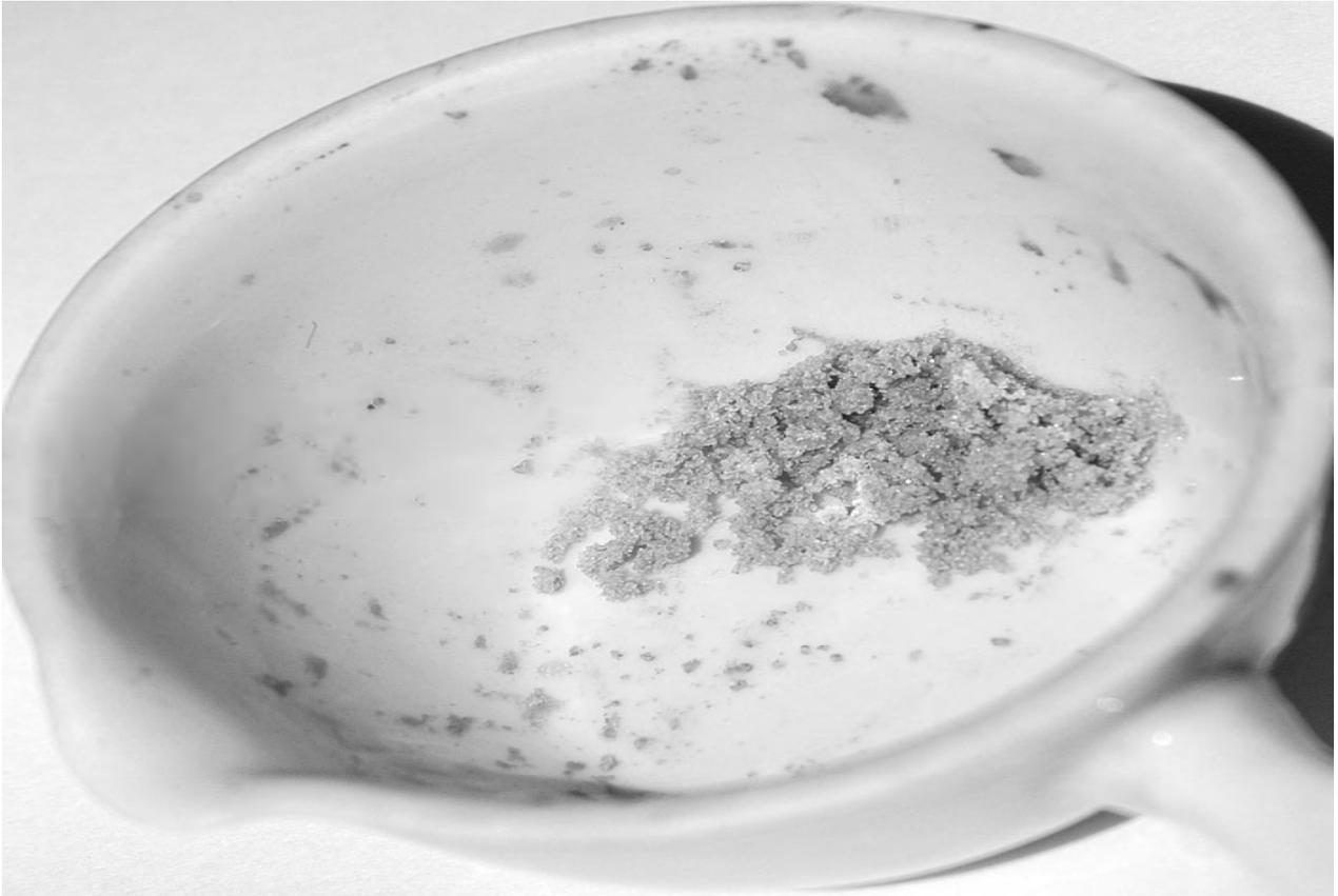
図5 鉄粉を希塩酸に溶かして加熱し，早めに加熱を止めて水分を少し残した試料を1日放置した状態
