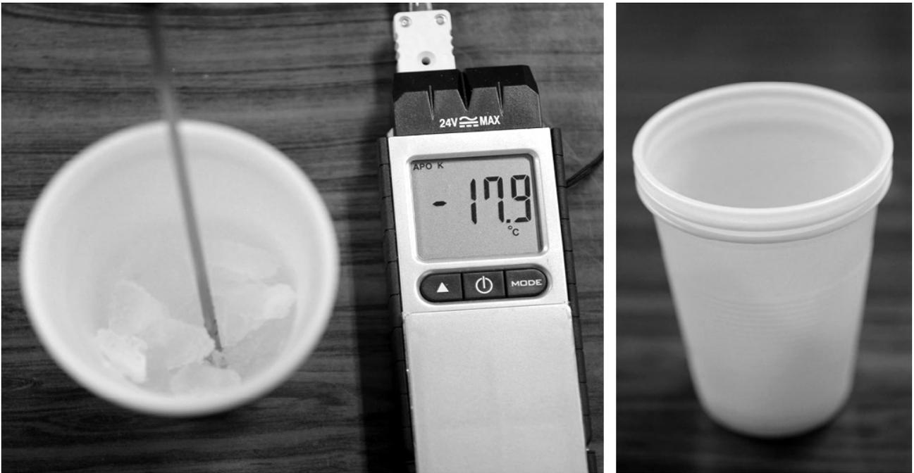
写真 氷に食塩の粒をまぶして温度を測る実験（終了後の様子）
