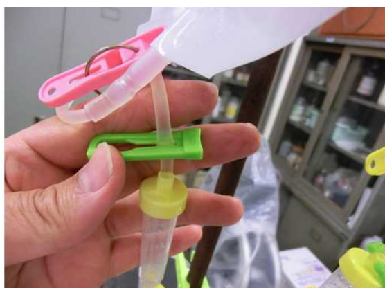
図2-14 液体の誘導 (誘導管の電池セルへの誘導およびストッパーと点滴筒)
