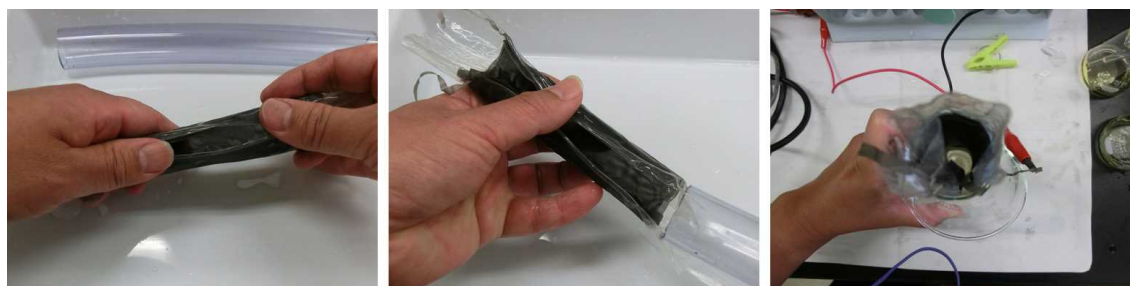
図2-11 チューブ式電池セル（正極を内側にして丸め、ビニールチューブに挿入する）
