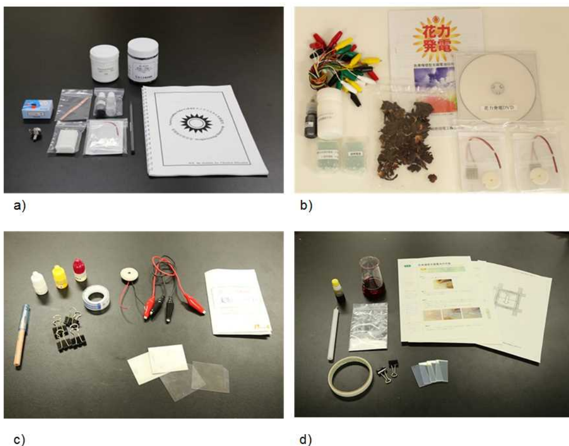
図1-14 市販キットと本研究の色素増感太陽電池 (a: K社, b: N社, c: P社, d: 本研究)
