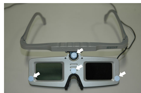
図 9 液晶シャッター眼鏡と赤外線反射ステッカ
