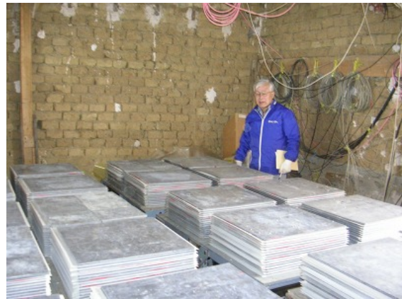
EC 建設後の様子。50cmX50cm の film を鉛板と交互に積み重ね、ハドロン検出器上に32ユニット設置した。
