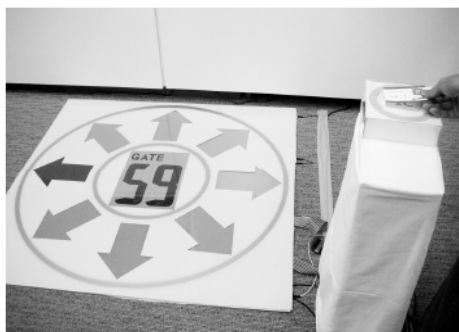
図 14 WYSIWYAS 案内板 (e タグをかざすと電子ペーパーで案内を提示)
