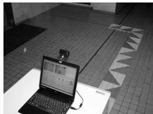
図11 一時的に敷設した点字ブロック
