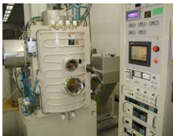
図1 反応性イオンプレーティング装置
