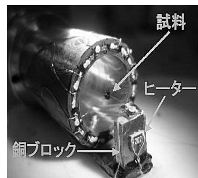
図5. 角度分解熱電能測定装置
