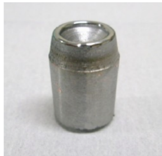
図4. 原料を封入した モリブデンルツボ。
