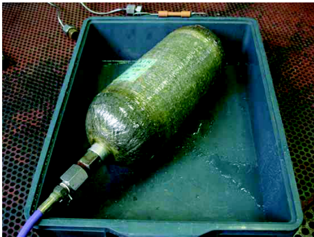
図1 圧力サイクル試験後の水漏れ状況
