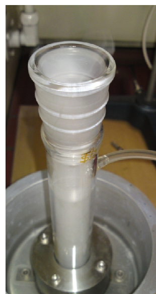
図1 超音波霧化装置及びヘキサンを霧化している様子
