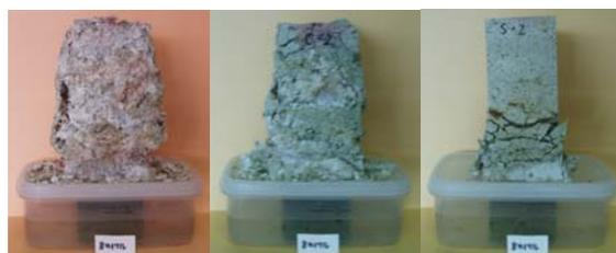
図 3 塩類風化実験 8 サイクル後の供試体の様子 (左:荒目、中:中目、右:細目)
