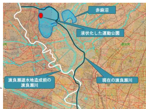
図2 液状化地点と明治期の河川・地盤環境 (歴史的農業環境閲覧システム 2) に加筆)
