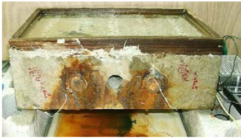
写真-1 電食試験終了直後(電食38日目)の電食供試体
