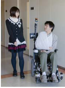
図 1 同伴者に自動併走するロボット車椅子
