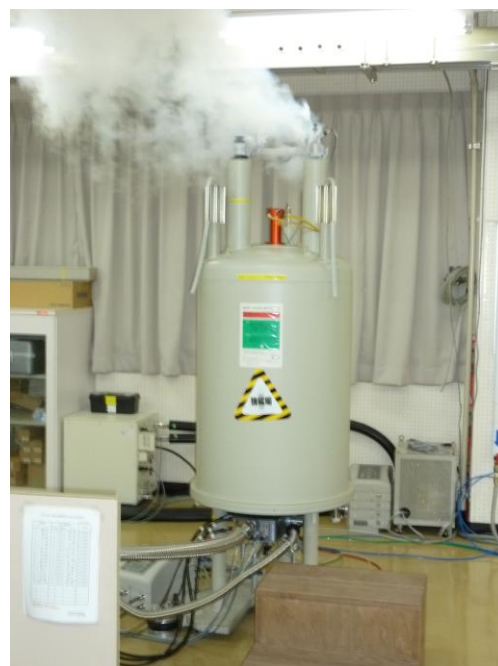
写真 クエンチを起こした超伝導磁石
