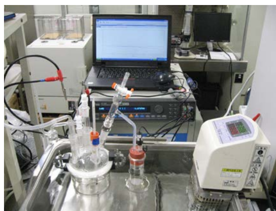
図11 ポテンシostatによる電気化学試験
