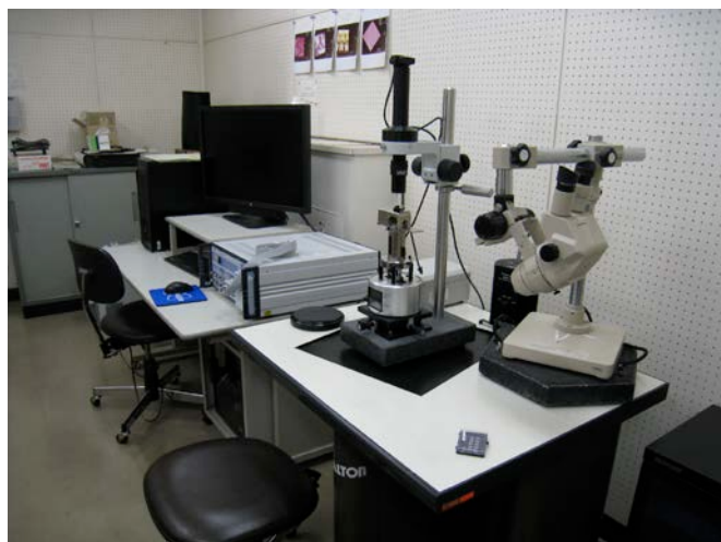
図1 AFM 装置 (MultiMode8) 左: 全体図, 右: 測定部
