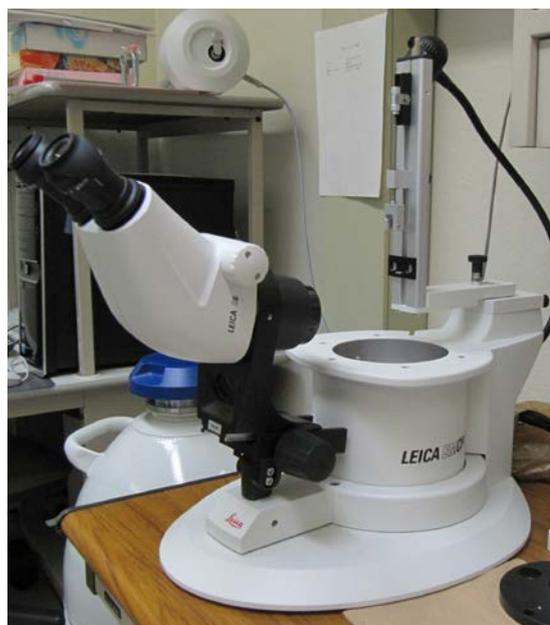
図 2 Leica EM CPC (急速凍結装置)
