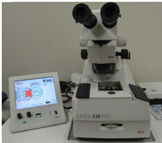
図 3 Leica EM FC7 (凍結ウルトラミクローム)
