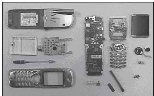
図 4. 携帯電話を人手により解体した部品類
