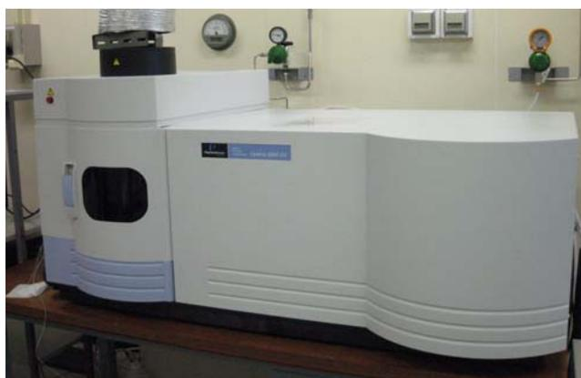
図 1. ICP 発光分光分析装置
