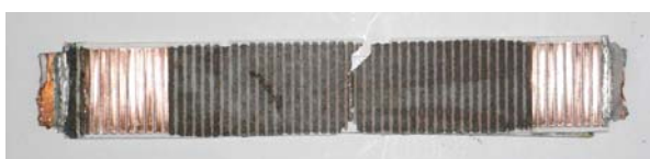
Fig.2 遮断後のエレメント図
