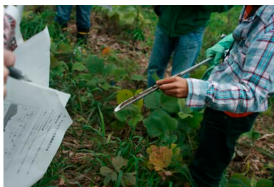
Fig. 1 検土杖を用いた土壌厚の測定
