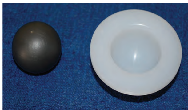
Fig.7 粗研削した骨頭球体 (左) と PE 白蓋 (右)
