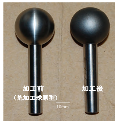
Fig.6 球原型 (A) の型彫り放電加工前後の写真
