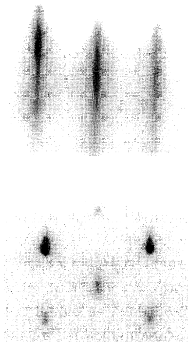
図 1 InN 成長後の RHEED 像 (a) 3C-SiC(001)上直接成長 (b) c-GaN(001)上成長
