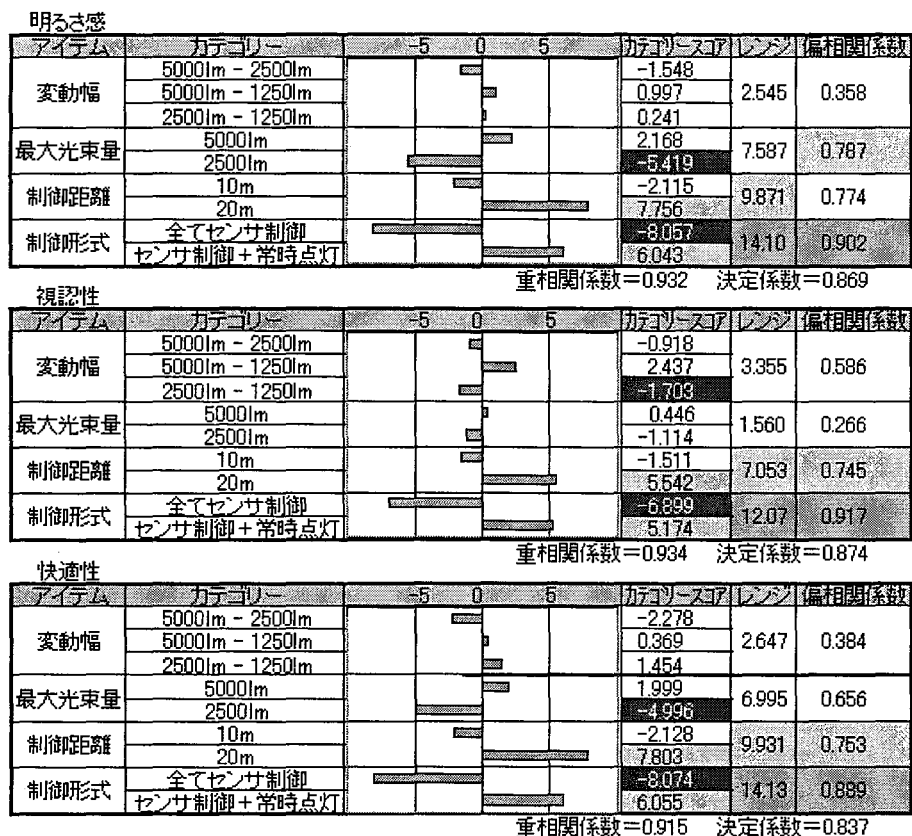
Fig. 5 制御要因が評価尺度に及ぼす影響 (林の数量化Ⅰ類による分析)
