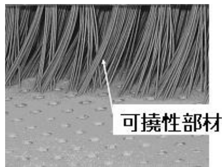
Fig. 5.可撓性ドレッサーの概観写真
