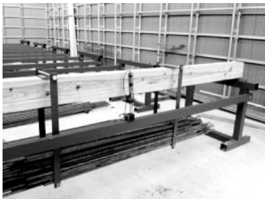
写真2 杉材・実大梁のクリープ試験 破壊荷重の15%の荷重(4点曲げ法)
