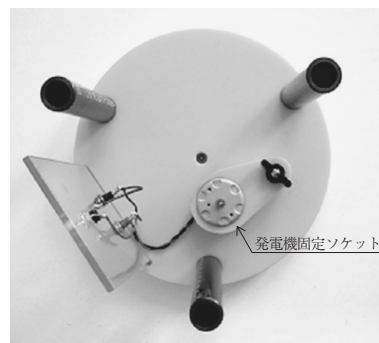
図3 本体発電機部
