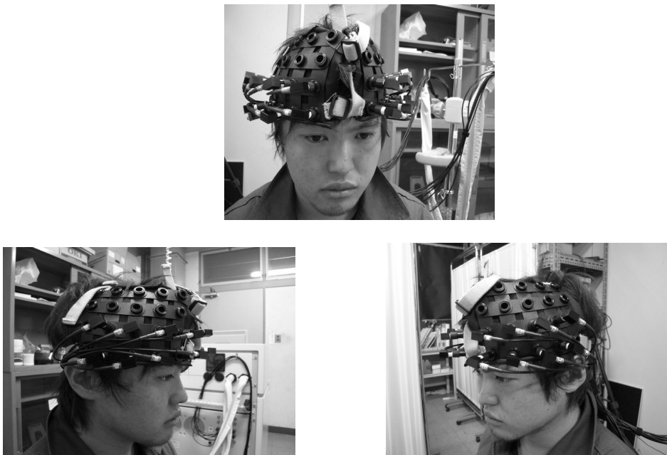
Fig. 3. ファイバホルダとプローブの装着部位
