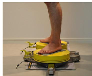
図2 多用途回旋角度測定器（横）
