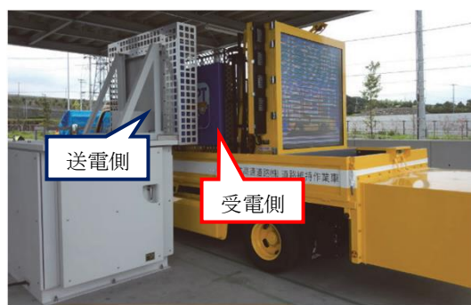
(c) EVトラックの給電（側面）
