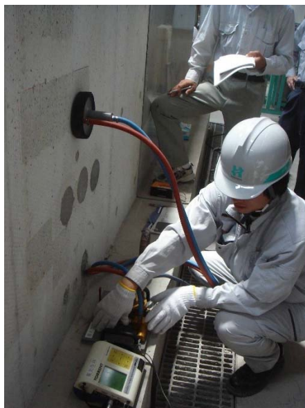
写真-3.4 透気試験状況
