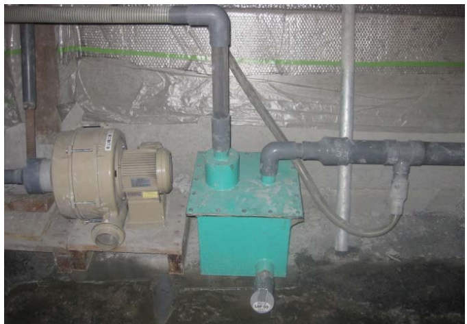
写真-3.9 吸引ファンおよび除水除塵機
