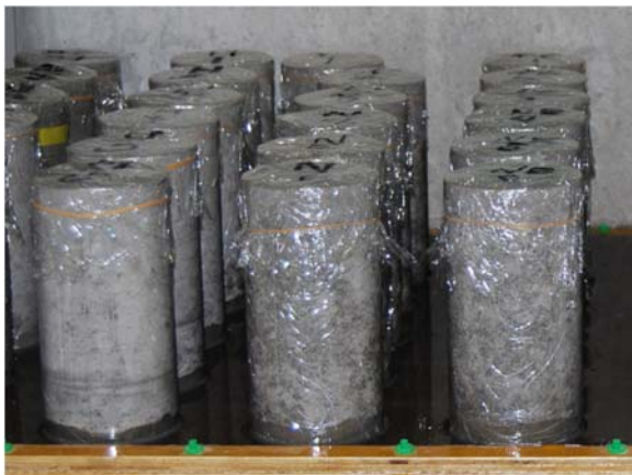
写真-3.3 供試体の吸水状況
