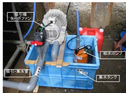
写真-3.6 吸引装置および給水装置配置例
