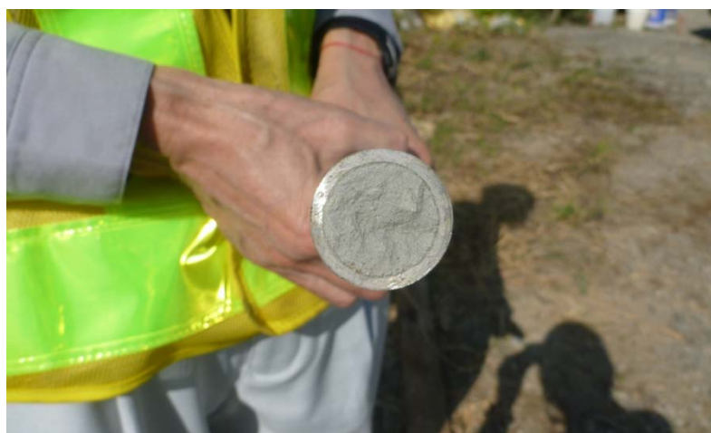
写真-2.3 パイプ内の充填状況（充填試験時）
