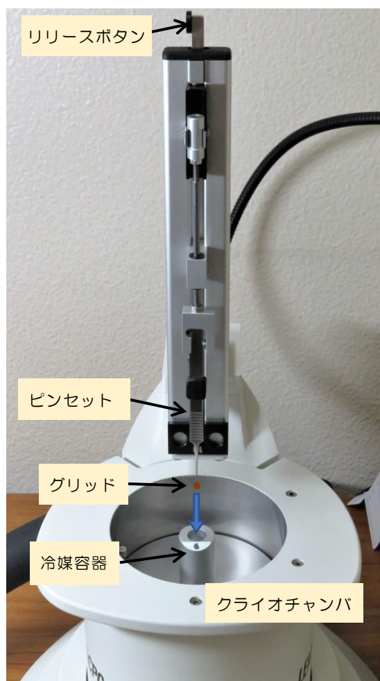
図1 急速凍結装置 Leica EM CPC
