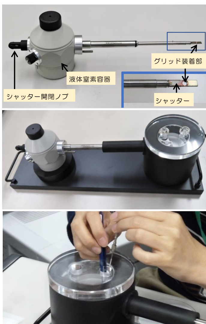
図 3 TEM のクライオトランスファーシステム 上)クライオトランスファー(CT)ホルダー 中)クライオワークステーションに装着した CT ホルダー 下)CT ホルダーへのグリッドの装着操作
