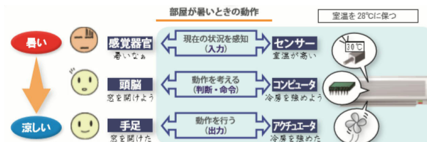
図2 自動化された製品（空調機器）のシステム構成
